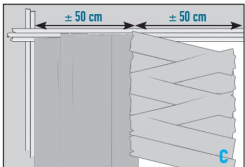
Wiederholen Sie dies, bis die Fläche des Projektionsschirmes vollständig bedeckt ist.
